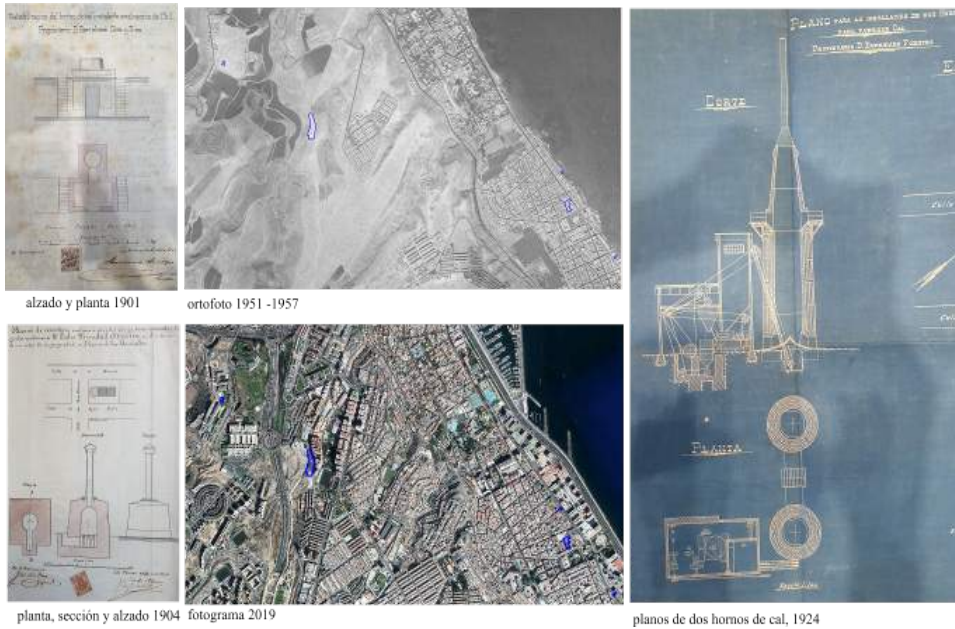
Figura 7. Planos de los hornos diseñados por Laureano Arroyo y Cirilo y la de dos hornos propiedad de D. Eufeniano Fuentes, en 1924 y fotogramas señalizándose la situación de los hornos en la ciudad de Las Palmas de Gran Canaria. Fuente: Archivo Histórico Provincial de Las Palmas y Grafcan.
