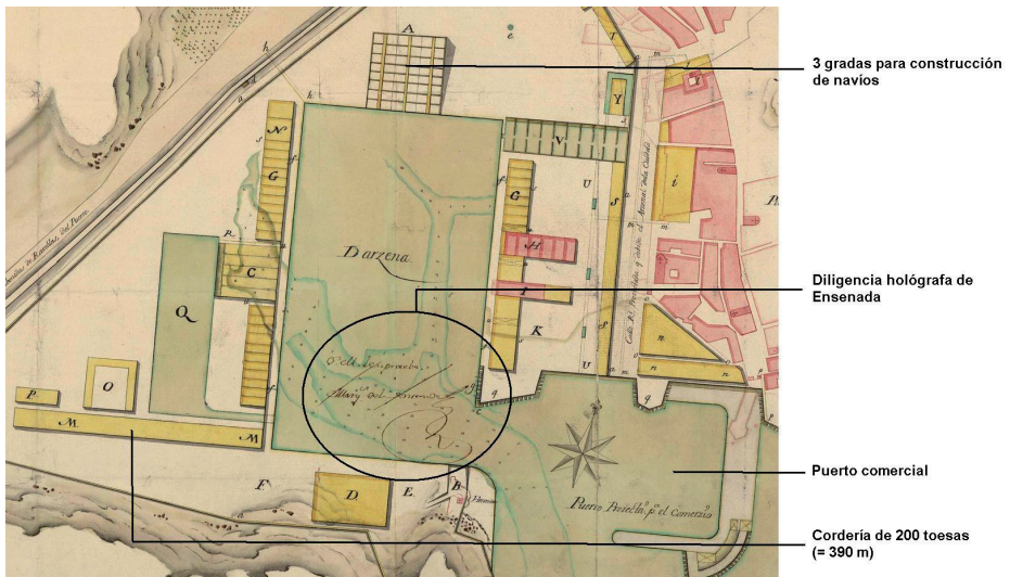
Figura 5. El proyecto de Feringán para Cartagena de 1749, donde se aprecia la excavación de la nueva dársena (1749)
