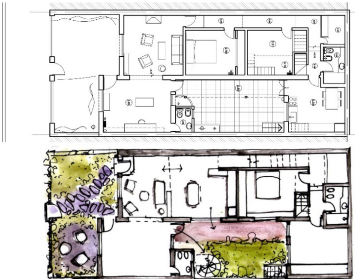
Figura 3. Casa chorizo antes y después de la reforma (Identificador KH7). Fuente: Estudio Khora (La Plata).
